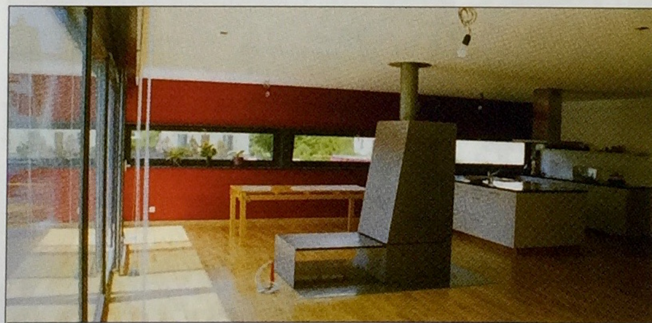
Matérialisation intérieure: lames de sapin sciées brut, giclées en atelier.
